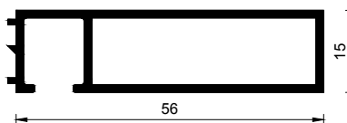
Tipo MT-6517 Premarco Peso estimado: 0.532 Kg/m Largo STD: 6200mm
